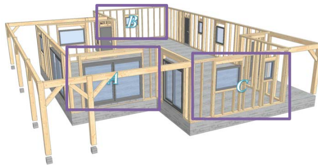
Figura 9. Esquema de montaje del muro con entramado de madera, incluidas todas las dimensiones
