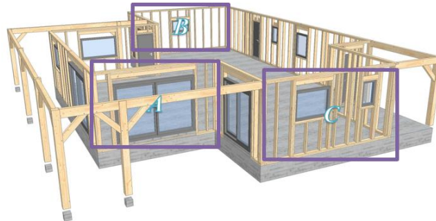
Figura 9. Esquema de montagem da parede com estrutura de madeira, incluindo todas as dimensões
