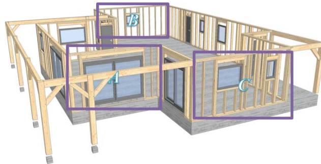
Figura 9. Esquema de muntatge del mur d'entramat de fusta, incloent totes les dimensions
